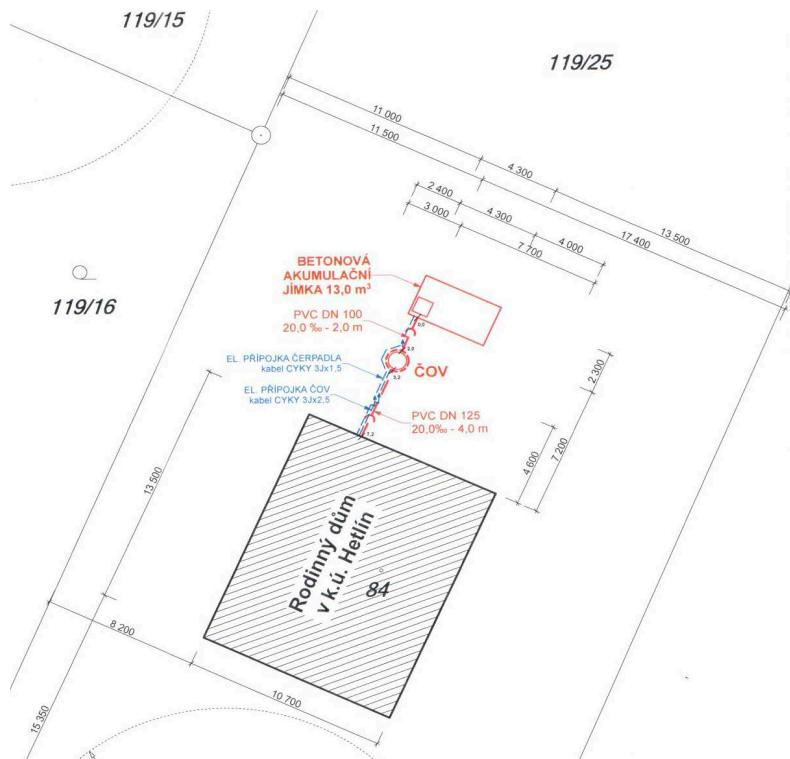
Součástí dokumentace záměru nakládání s vodami je hydrogeologický posudek, v jehož závěru se uvádí, že je optimální likvidovat přečištěné odpadní vody na uvedeném pozemku rozstřikem. V zimním období a za klimaticky nepříznivých podmínek budou vyčištěné vody akumulovány ve stávající jímce o objemu 13 m<sup>3</sup> a aplikovány na pozemek budou po rozmrznutí nebo dostatečném vyschnutí půdy. Možnost kvalitativního ovlivnění zdrojů podzemní vody v okolí se nepředpokládá.
